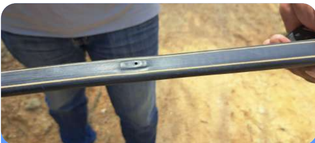
ท่อน้ำหยดรุ่น DripNet™ PC เหมาะกับการฝังใต้ดิน และมีระบบขดเคียวแรงดัน
